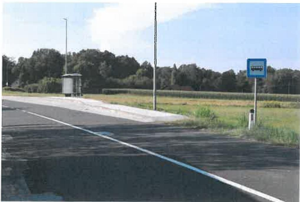
Avtobusni postajališči sta opremljeni z vertikalno in horizontalno prometno signalizacijo ter z nadstrešnico. Avtobusi ustavljajo na odstavnem pasu. Potniki imajo nivojsko ločen hodnik od cestišča. Iz prometne varnosti so potniki izpostavljeni nevarnosti, ker ni prehoda za pešce med postajališčema. Na tem delu je hitrost omejena na 60 km/h.
