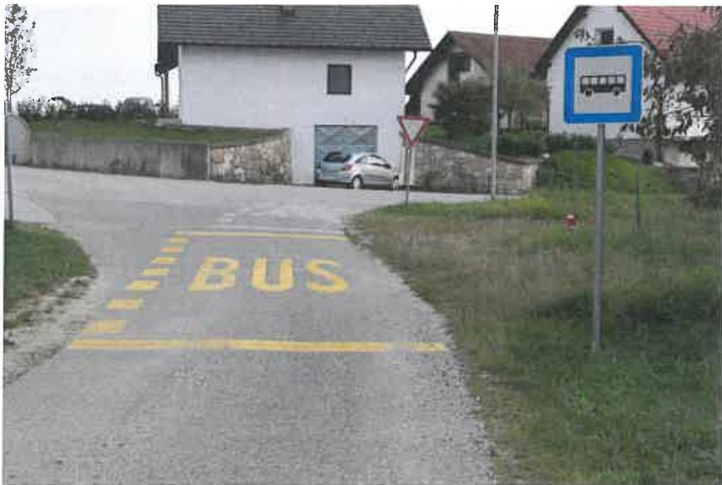
Avtobusno postajališče je opremljeno z vertikalno in talno signalizacijo. Avtobus to postajališče uporablja kot obračališče. Postajališče je iz prometne varnosti nevarno, saj avtobus stoji na vozнем pasu, kjer je omejitev hitrosti 50 km/h.
